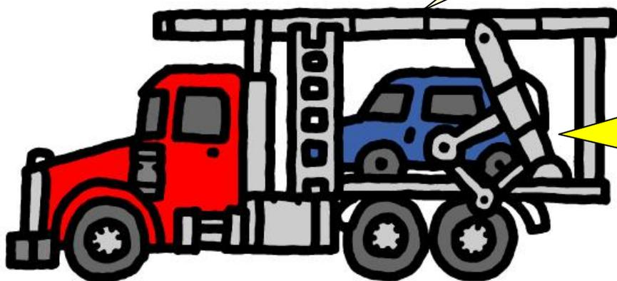
積載車両の積卸し後は、必ず、**スライド荷台や道板の格納、セルフローダー車体の降下復元**を行い、**走行時の状態で駐車**して下さい。
