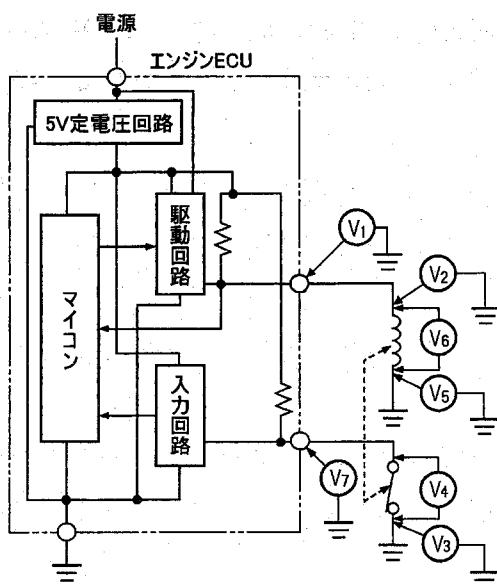
図2 アクチュエータ駆動電圧特性
