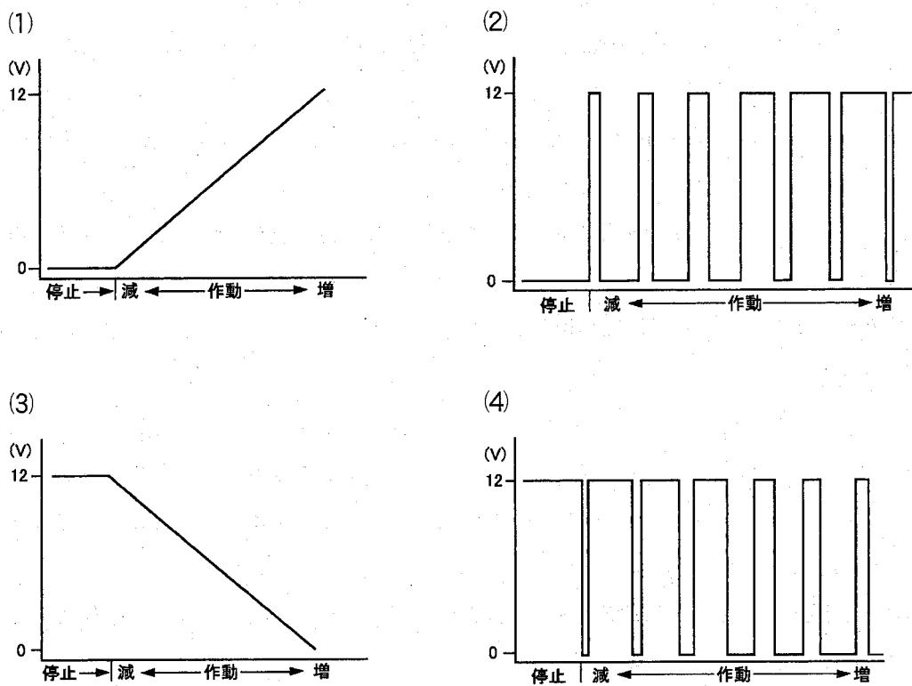
[No. 8] 図に示すスイッチ駆動アクチュエータの点検に関する記述として、不適切なものは次のうちどれか。ただし、駆動回路内の電圧降下及び重複故障はないものとする。
