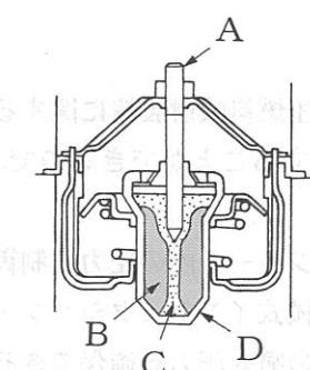
[No. 10] 図に示す4シリンダ用の分配型インジェクション・ポンプのプランジャにおいて、ディスク・トリビュータ・スリットを表すものとして、適切なものは次のうちどれか。
