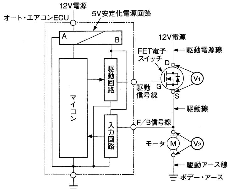
図 駆動回路構成
