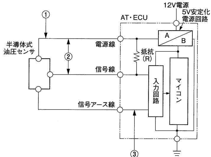
図2 半導体油圧センサの回路構成
