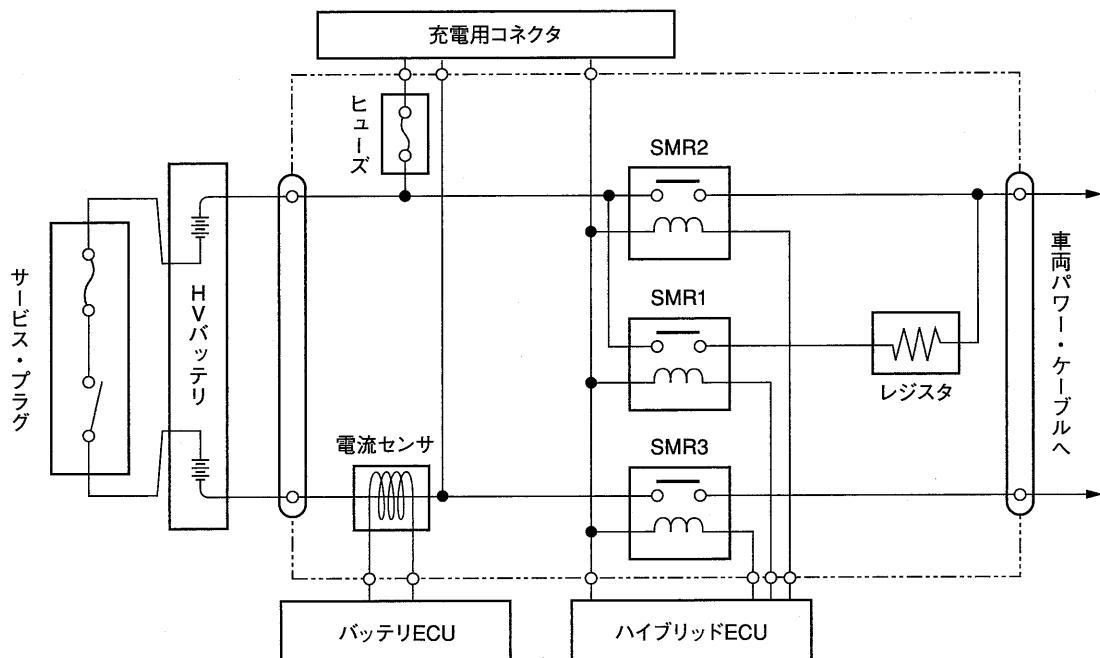
図 ハイブリッド・システムのシステム・メイン・リレー(SMR 1, SMR 2, SMR 3)回路
