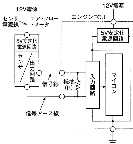
図1 热線式エア・フロー・メータ回路
