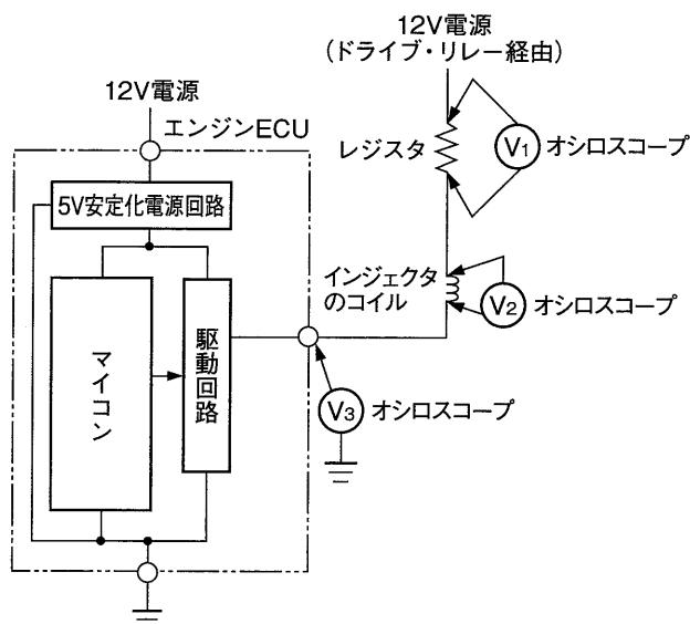
図 駆動回路構成
