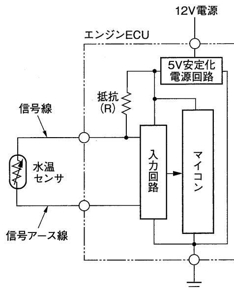
図2 水温センサ回路
