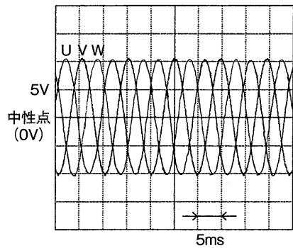
図1 定速回転中の駆動電圧波形
