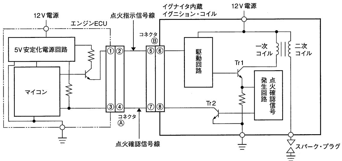
図 イグナイタ系統の回路構成
