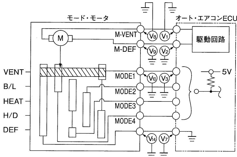
図 モード・モータの回路構成
