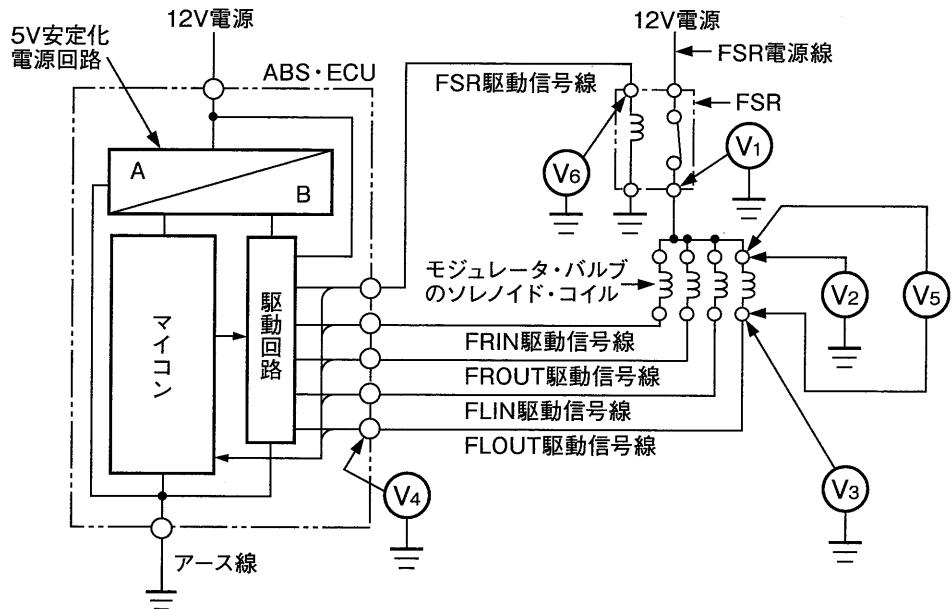
図 駆動回路構成
