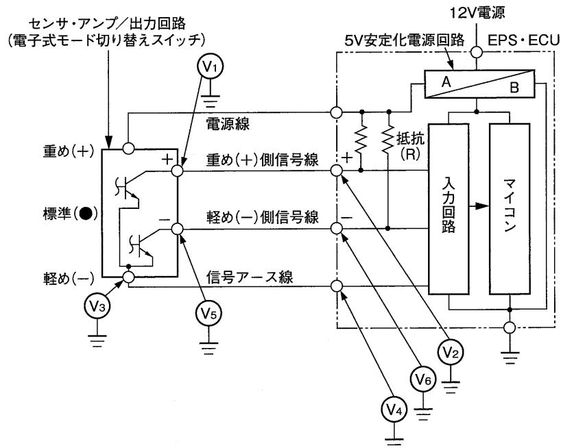
図2 EPSの電子式モード切り替えスイッチ回路構成
