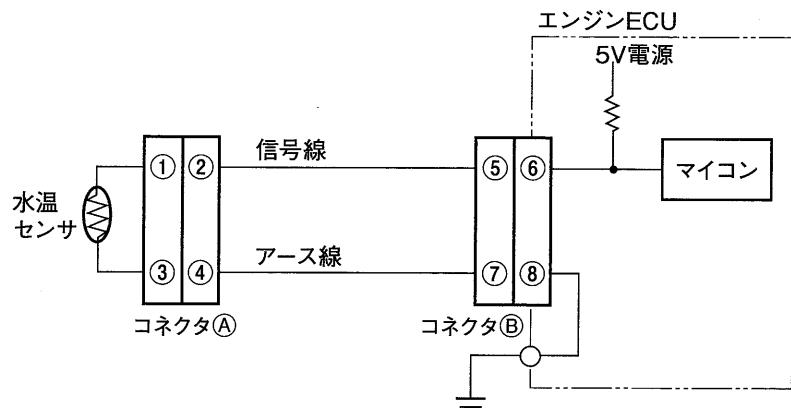
図2 水温センサ回路
