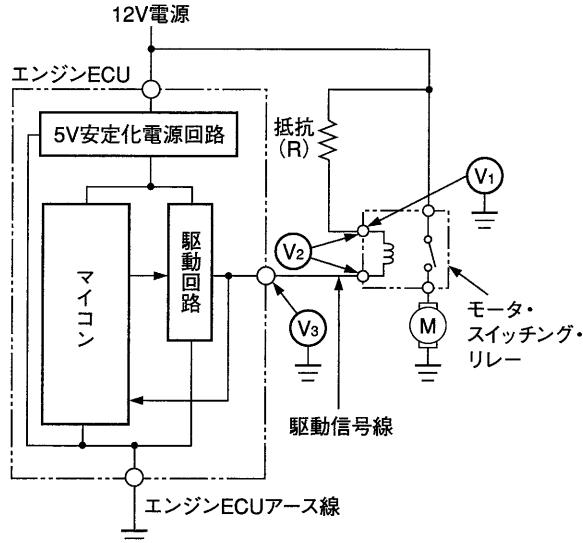
图2 驱动回路构成
