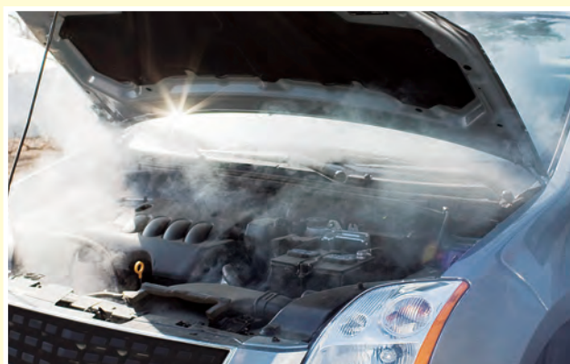
冷却不良によるオーバーヒート
