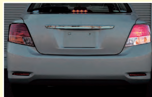
電球が切れたため点灯しないブレーキランプ
